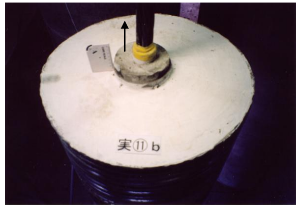
写真-6 摩擦型アンカー引抜け状況
