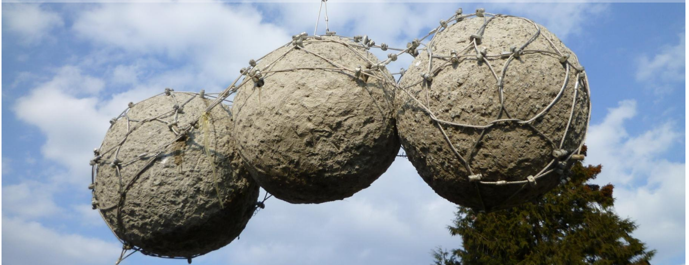
ワイヤーリングネットでコンクリート球(φ 1m 3ヶ, 3.6t)を吊り上げた状態...ワイヤーネットの自在性を活用することで、バランスのとれた状態を確保できる
