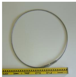
ワイヤーリング(ロープ径8mm, ステンレス製, 工場加工)
