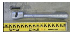
アンカーピン(ワイヤーネットと石を一体化せしめる部材. 打設地盤の表層剥離を防ぐくさび方式. ダクタイル製)
