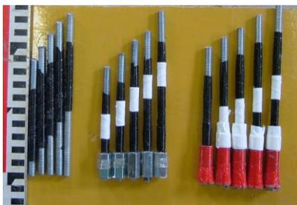
写真-8 実験用引張材(左から引張型、圧縮型、くさび型)
