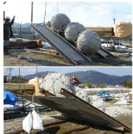
写真-4 滑動実験 (後方に  $45kg$  の土嚢アンカーを取付けている)
