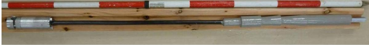
深層アンカー ( $l=1\sim 2\text{m}$ , 削孔径 65mm, 二重防錆, 人力施工)
