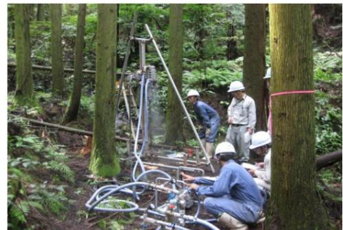
全地盤サウンディング試験測定状況
