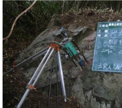
写真-7.1.2 アンカーピン基本調査試験
