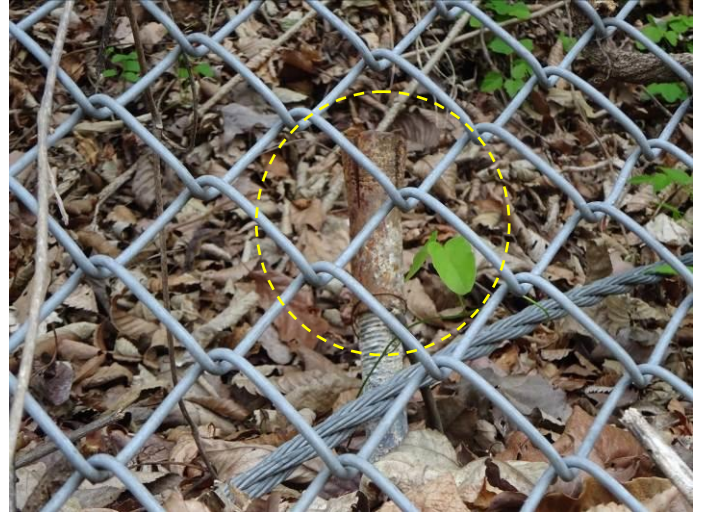
岩用アンカー（長さ1m）の引き抜け
