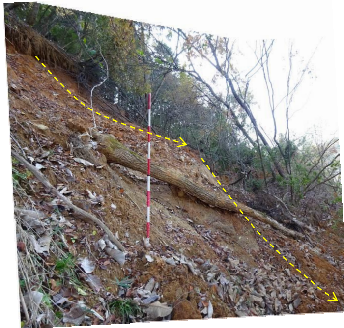
基岩面変化点（上部は退行性滑落崖）
