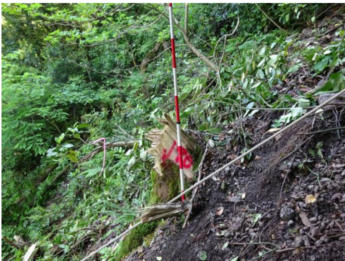
φ 1m 大の落石による破断力（立木 φ 35cm）
