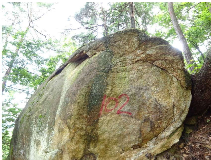
タマネギ状風化（花崗岩）：直接アンカーを設ける場合は、表層 20~30cm の被りを考慮する必要がある。
