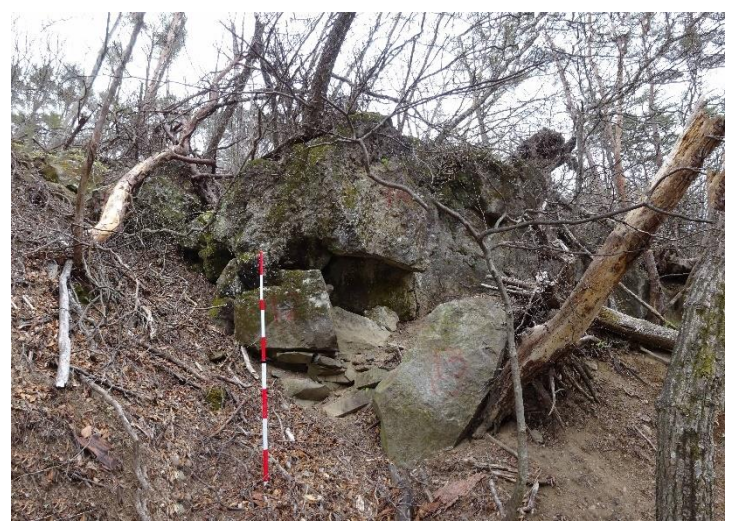
④倒木による急崖脚部の抜け出し
