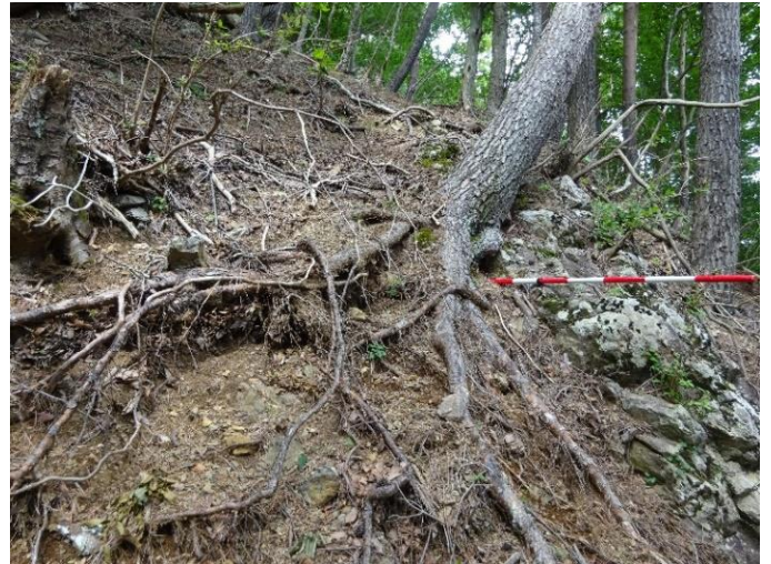
パイピングによる岩片（玄武岩風化帯）の噴出→表層地盤空洞化→倒木→落石等の誘発
