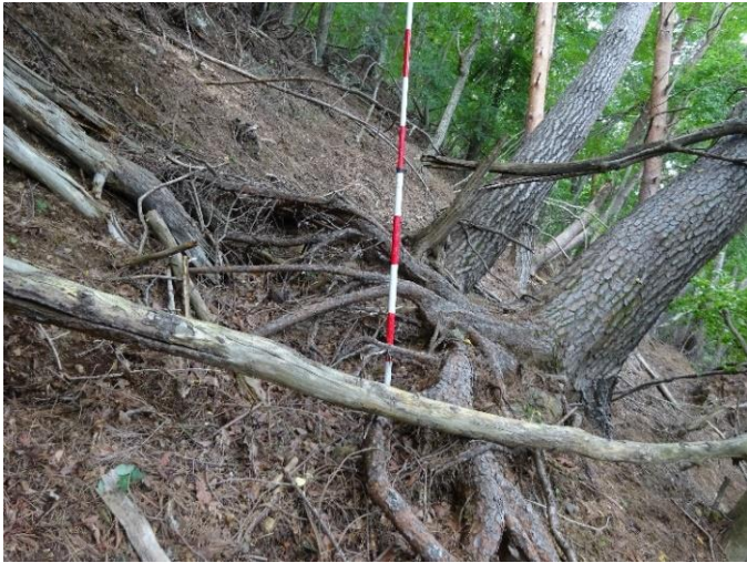
パイピングによる岩片（玄武岩風化帯）の噴出→表層地盤空洞化→倒木→落石等の誘発
