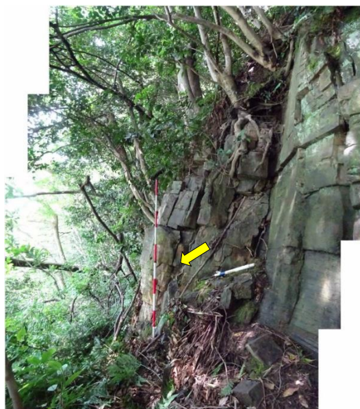
写真-3.2.13 旧滑落崖の退行性侵食
