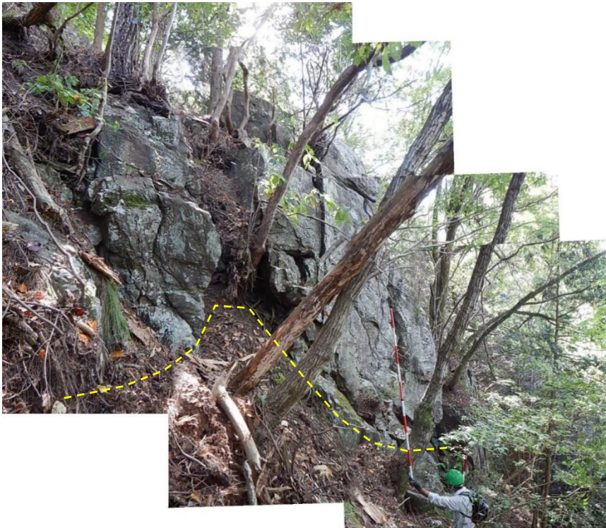
図 2.4 安山岩風化層の地すべり断面（すべり面粘土と湧水なし）
