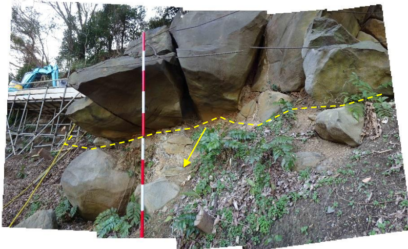
図 2.6 玄武岩質火砕岩層の地すべり末 端部（すべり面粘土と湧水なし）
