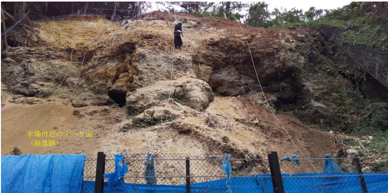
図 2.3 琉球石灰岩のすべり，傾斜 45°（層厚 3～6m. すべり面粘土と湧水なし）
