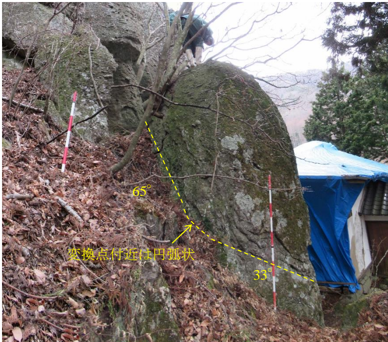
同左，下流側破断面・・・破断面角 20^\circ （層理面に一致）
