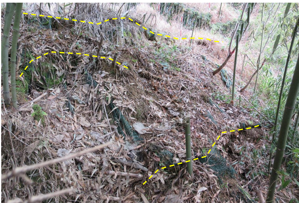
①横断クラックのみで、斜面縦断方向の連続したキレツなし
