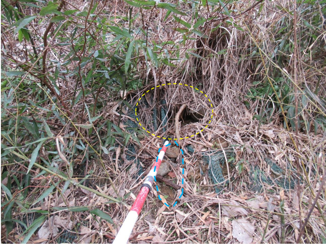
②地下水の噴出跡：空洞の形成と礫の噴出. 表土層 0.2m 以下は風化岩
