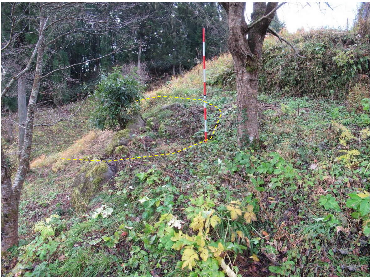
同上、直上付近（遷急点）の局部的キレツ…広範囲に滑動する斜面内の挙動
