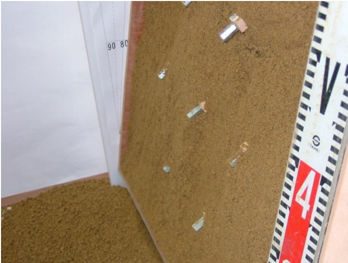
補強材をすべり面に対して低角度で設置：傾斜 80°
