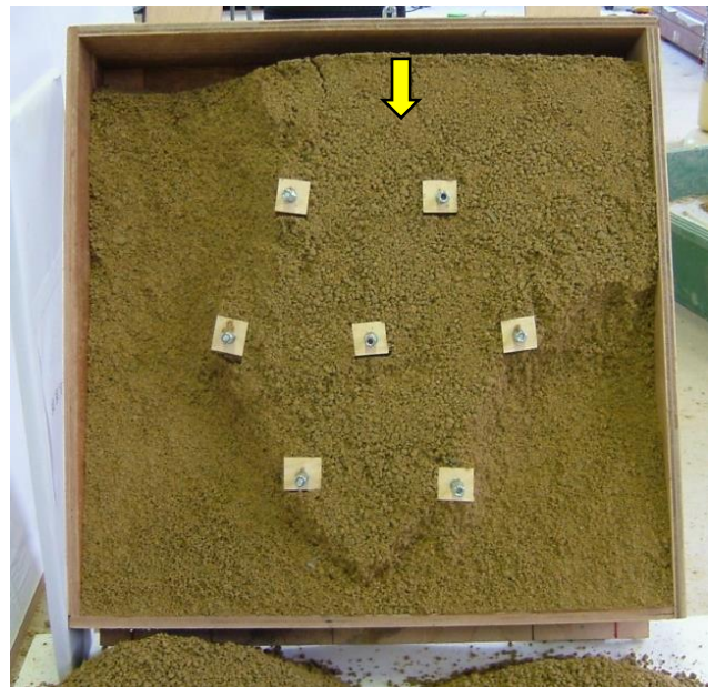
頭部連結効果（法面工で一体化下方が、抑止力が高い）
