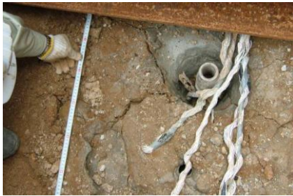
写真-9 引張型アンカー体引抜けともなう地表の盛り上がり状況 (図-29A)
