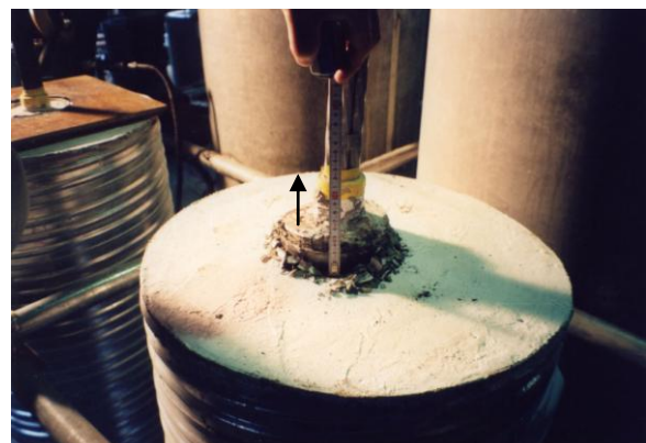
写真-7 クサビ型アンカー引抜け状況
