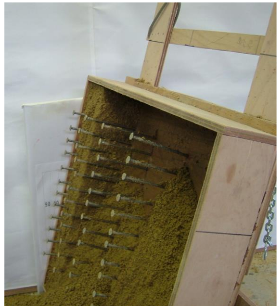
参考写真—4 傾斜 75° ○9cm 幅区間で崩落
