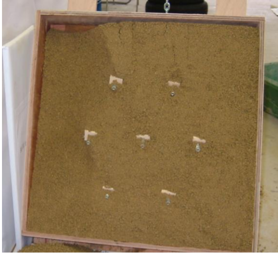
写真一七 マサ土における受圧版の荷重分散角 (傾斜 65^\circ で崩落)
