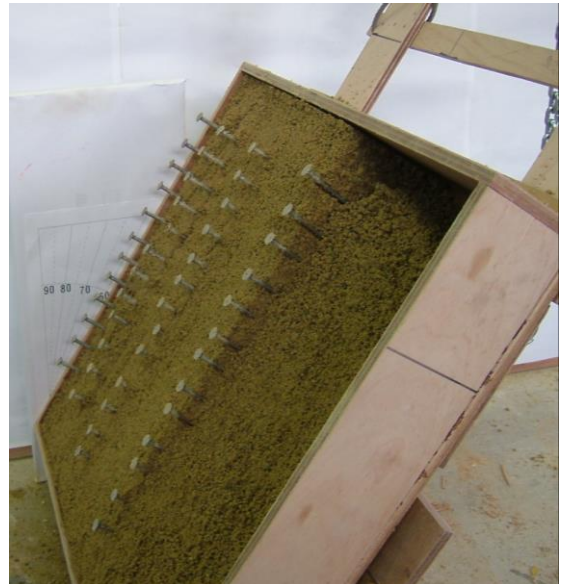
参考写真—2 傾斜 60° ○18cm 幅区間で最初に崩落
