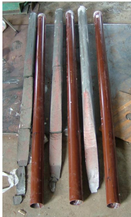
写真 1.4.1 ブリージング状況
