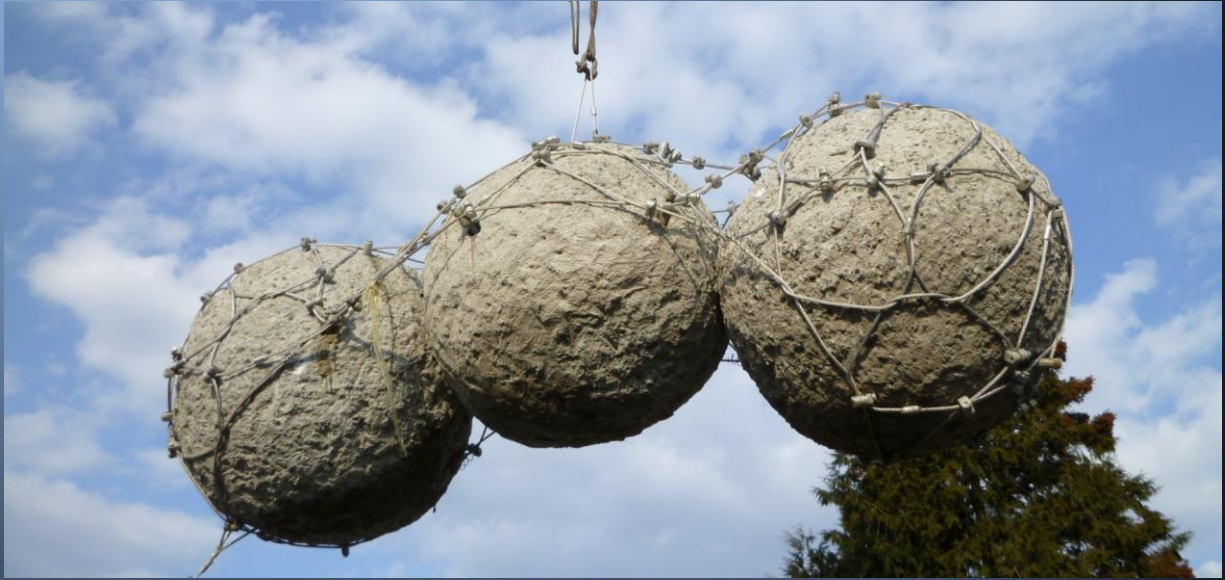
ワイヤーリング1ヶ(ロープ径8mm)でコンクリート球(3ヶ, 3.6t)を吊り上げた状態 (ワイヤーネットの自在性を活用することで、よりバランスのとれた状態を確保できる)
