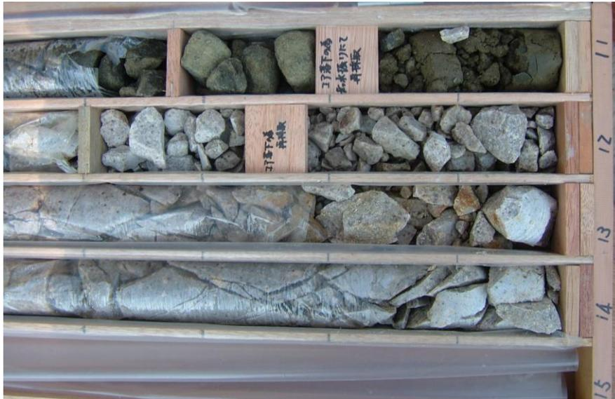
亀裂が発達し、孔壁の肌落ちが著しい花崗岩層（定着地盤）
