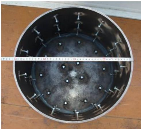
写真 2.2.1 試験体型枠
