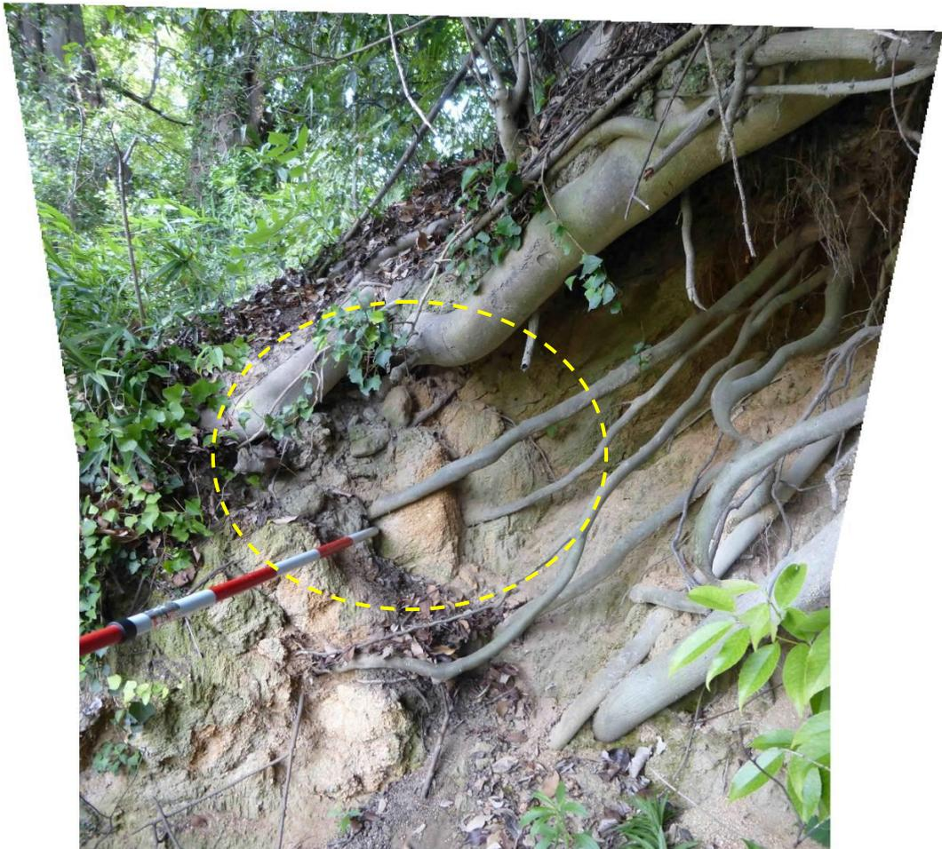
…倒木による外力(便宜的に地震力に置き換える)や転倒の検討を行わず、滑動計算のみで検討する場合は、対策不要となりかねない。
