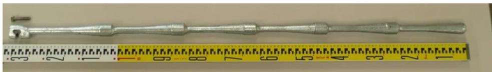
○深層アンカー（C20型：削孔径 50mm，定着長 20cm）
