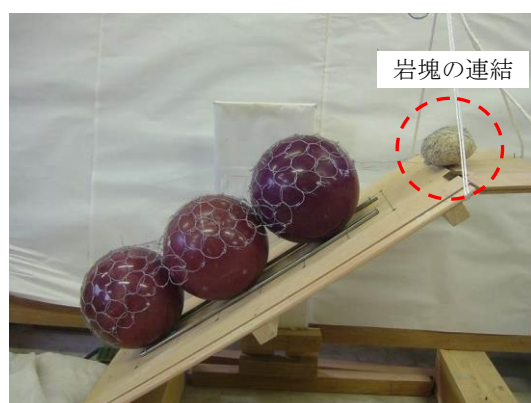
写真-参 2.1.2 ワイヤーネットによる岩塊の連結効果
