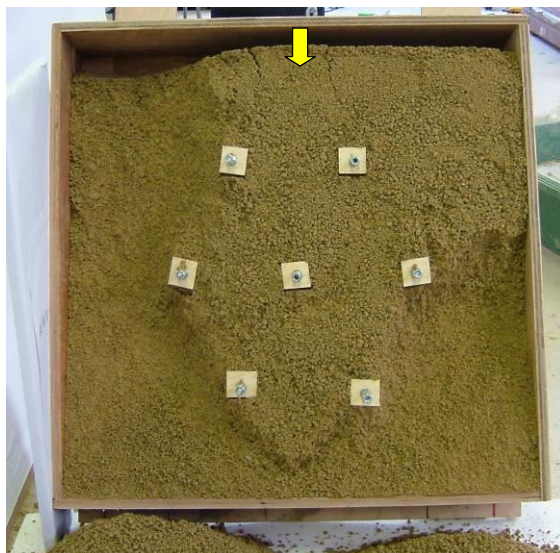
写真-参 2.5.10 アンカー工のみの場合 (傾斜 65^\circ で周囲が崩落)
