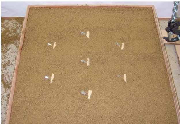
写真-参 2.5.1 受圧版セット状況 (試料枠：56×56×10cm. 試料はマサ土)
