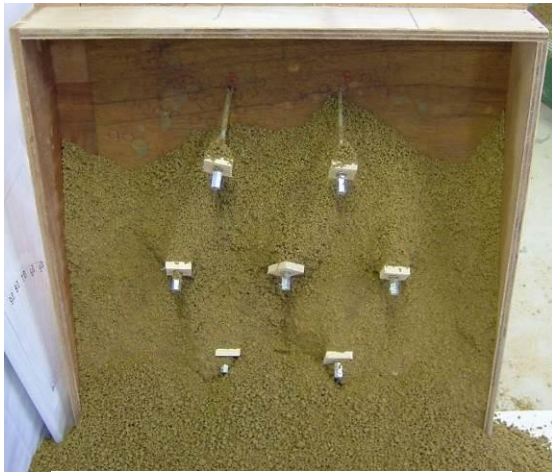
写真-参 2.5.5 崩落状況
