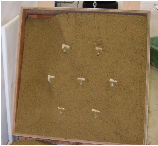
写真-参 2.5.3 傾斜 65° で崩落
