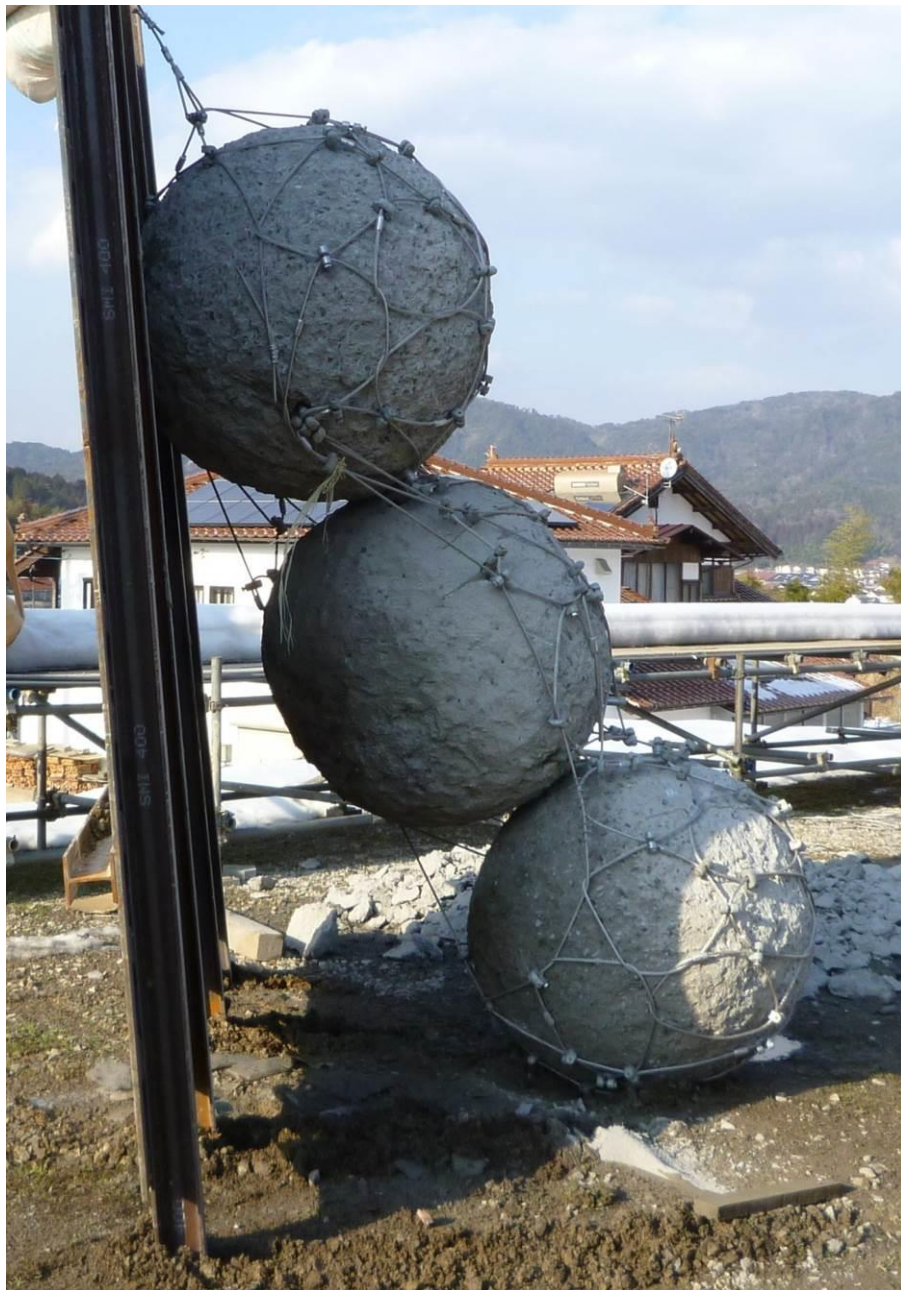
写真-参4.1.9 ワイヤネットの拘束力により3連結のコンクリート球3.6tが一体化を保っている状況
