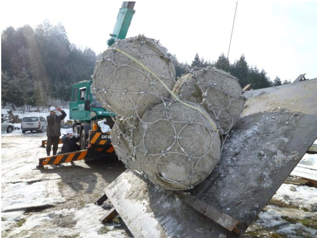
写真-参 4.1.6 傾斜 40° の状態 (黄色テープは実験前に鉛直方向に取り付けたもの)
