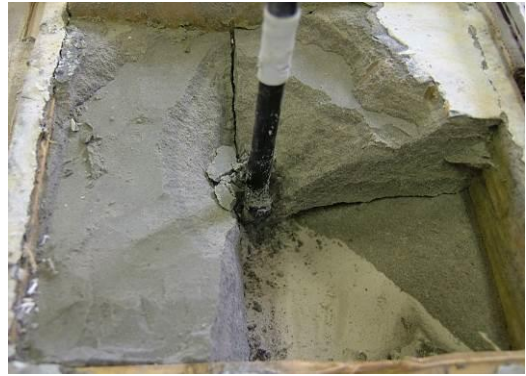
写真一参 4.3.7 圧縮型：拘束具先端部から剥離（埋設深さ 50mm）
