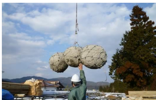
写真-参 4.1.8 ワイヤーネットの強度および拘束力を確認するため、ネットを構築するワイヤーリング(φ35cm, ロープ径 8mm) 1本により全体を吊り上げた状態
