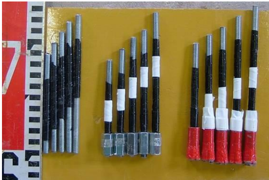
写真-参 4.3.1 実験用引張材 (左から引張型，圧縮型，くさび型)
