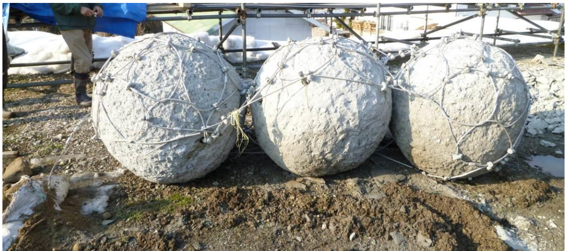
写真-参4.1.10 上記状態から最大3m落下した後の状態（ネット部材等に異常なし）
