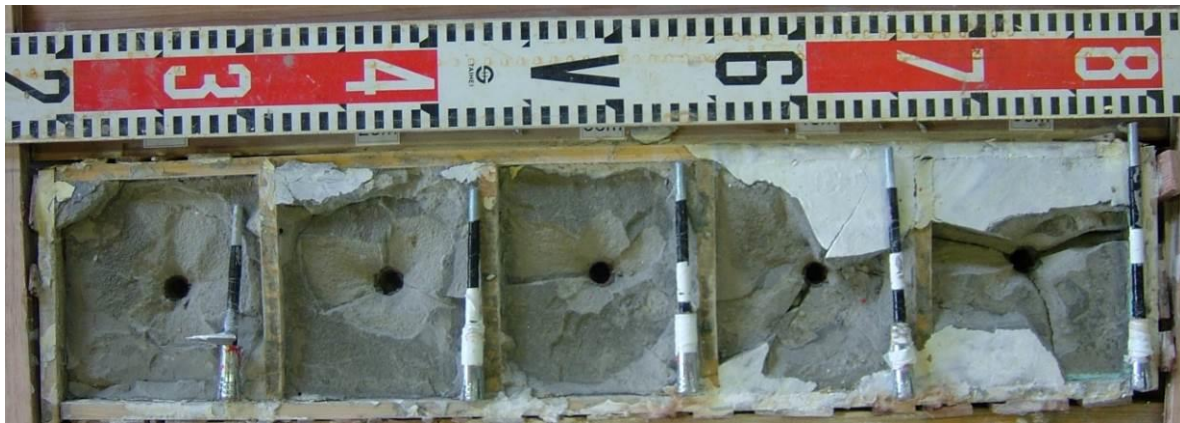
写真一参 4.3.5 くさび型アンカー体引抜き後の状態
