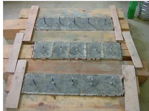
写真-参 4.3.2 各アンカー体定着状況
