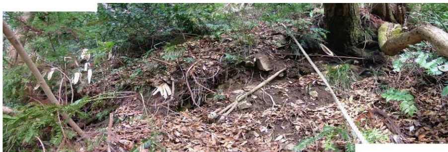
層厚 3~5m の表層すべり（中腹部押し出し）
