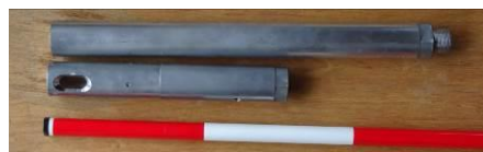
(上) 延長材, (下) 頭部連結具と固定金具を連結した状態
