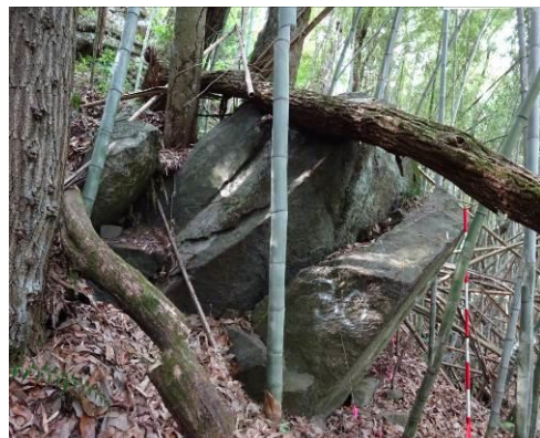
写真-3.3.2 同上、転倒の恐れが高い岩塊
