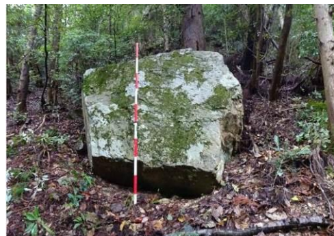
写真-3.3.1 斜面上の転落岩塊
