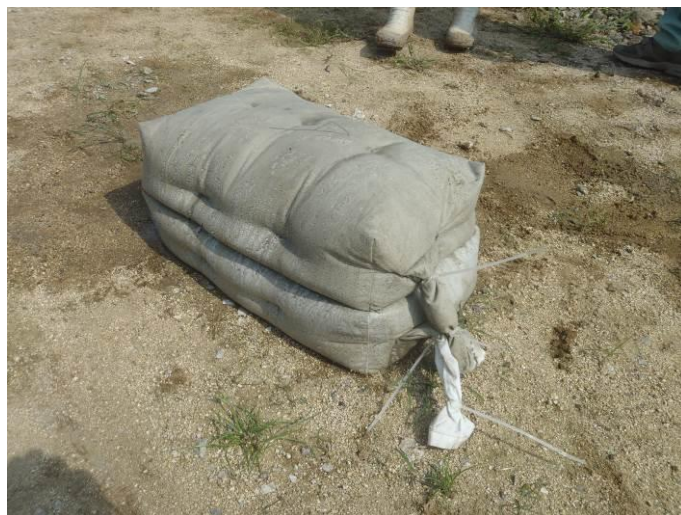
グラウト後 (2段積み状態)
