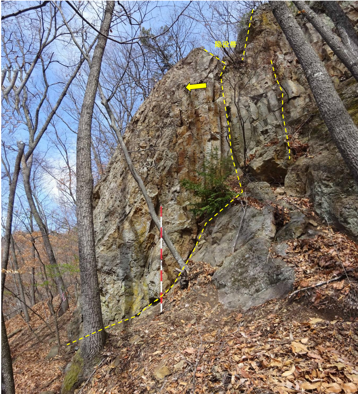
岩盤すべり（安山岩，板状すべり），頭部はトップリング状
