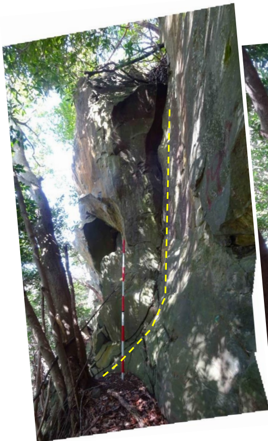
小規模な岩塊すべり：（安山岩，すべり面傾斜 40^\circ ，頭部剥離面からすべり面へ移行する位置は円弧状
