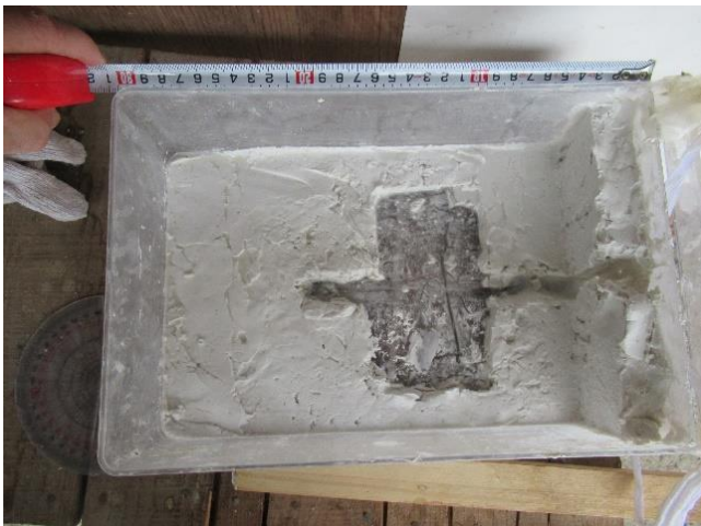
写真 9 揚圧力作用領域の拡大 (すべり面)
