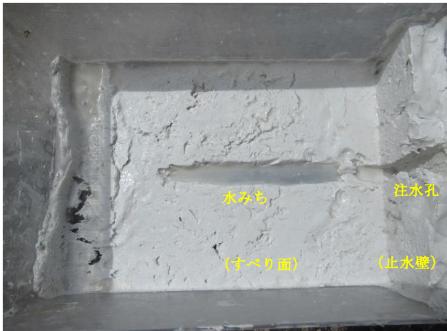
写真 5 注水孔と水みちの位置 (実験後の状態)
