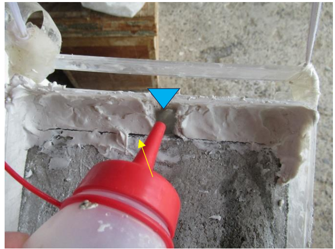
写真 12 注水による剥離進行状況
